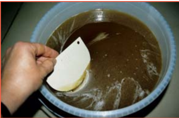
Abb. 21: Wachspartikel werden mit einem Teigschaber zusammengeschoben.
