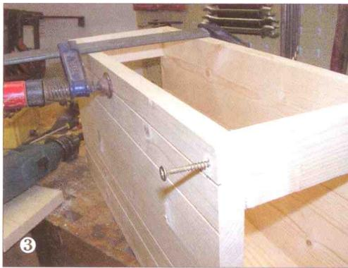
❺ Die Montage von Flugloch- und Rückseite: Von innen an die Griffleisten drücken und von außen mit je 2 Schrauben 40 mm befestigen. Unten stehen die Schmalseiten am Boden auf und 20 mm zurück. Jetzt diese senkrecht fixieren (4 × je 2 Schrauben von der Seite). Je nach Ohrlänge der Rähmchen eventuell Holzleiste auf der Auflagenfläche anbringen.
