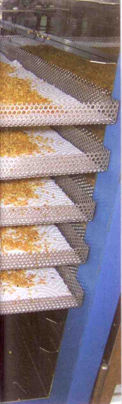
◀ Unser Trockenschrank aus Edelstahl hat eine Kapazität von 5 kg/24 h. Die einzelnen Lochbleche sind mit Haushaltspapier abgedeckt, damit die Pollen nicht durch die etwas zu großen Löcher fallen. Foto: Heiser
