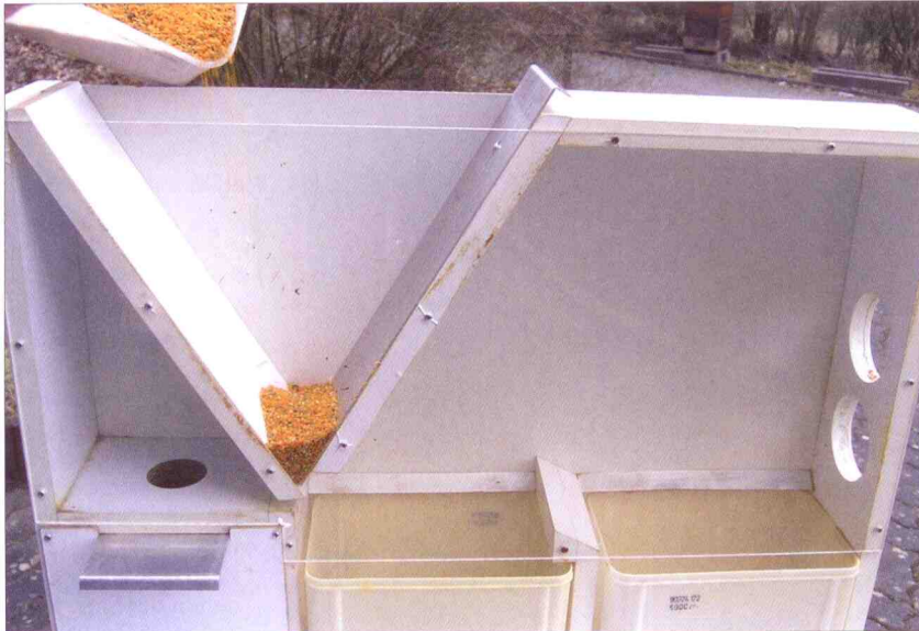
◀ Unser Trockenschrank aus Edelstahl hat eine Kapazität von 5 kg/24 h. Die einzelnen Lochbleche sind mit Haushaltspapier abgedeckt, damit die Pollen nicht durch die etwas zu großen Löcher fallen. Foto: Heiser
