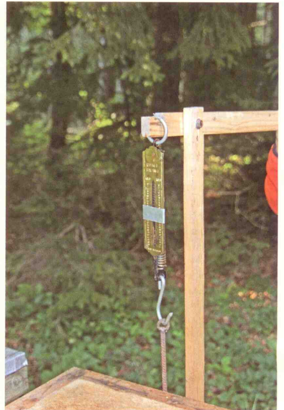
Eine einfache Hebelkonstruktion aus Holzleisten mit einer Federzugwaage ermöglicht das Wiegen mit geringem Kraftaufwand und ein Ablesen in Augenhöhe.
