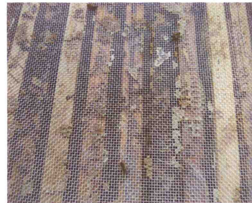
Sieben der zehn Produktionsmittel für die Propolisgewinnung bestanden den Test nicht. So erwiesen sich auch sämtliche Varianten aus Edelstahl (Foto oben) und aus Glas (Foto unten) als ungeeignet. Fotos: Schroeder
