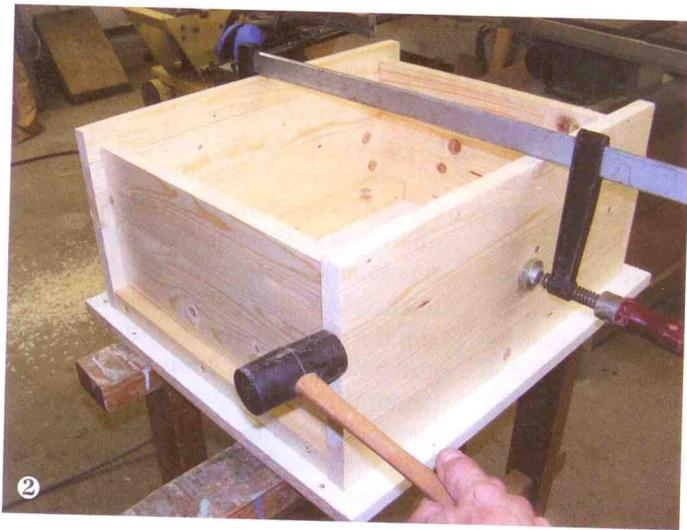
2 Jetzt beide Seitenteile und die vormontierten Stirnseiten außen an die Montagehilfe stellen. Die Setzleisten müssen unten bündig mit den Seitenteilen abschließen. Es hilft, die vier Teile mit einer Schraubzange zu fixieren, evtl. mit Gummihammer genau ausrichten. Bitte darauf achten, dass alle Teile plan auf der Montagehilfe aufliegen.
