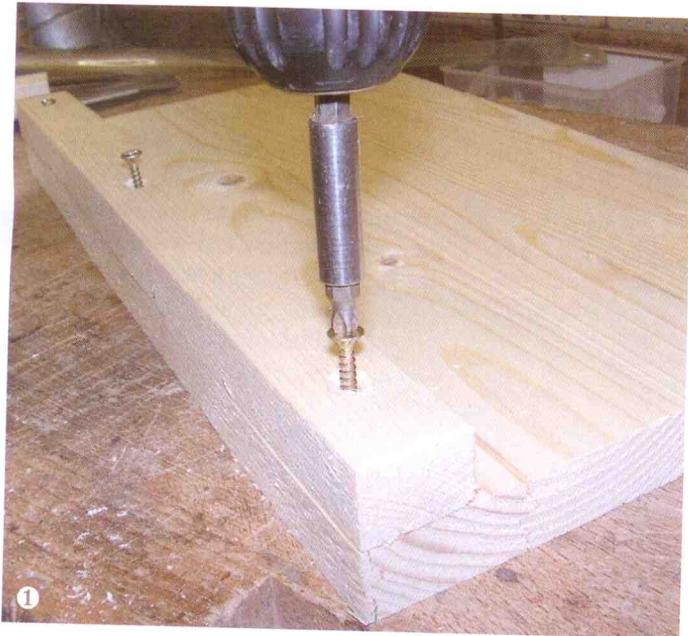
1 Zunächst an den beiden Stirnseiten die Setzleisten vormontieren (jeweils drei Holzschrauben, max. 40 mm lang).
