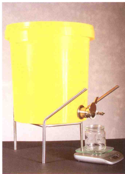
Genial einfach: Auf dem Abfüllbock steht die Abfüllkanne entweder waagrecht oder gekippt. Er wird dazu nur umgedreht.
