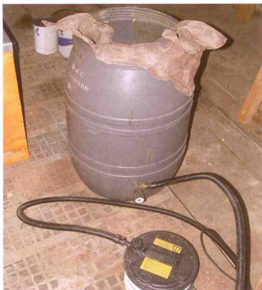
In einer Plastiktonne lässt sich mit dem Dampfmeister sehr gut Baurahmen- und Restwachs einschmelzen. (s. a. 08-01-03).
